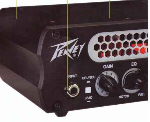
niewielkich wymiarów i wagi, zastosowano tutaj układ tranzystorowy. Do kreacji odpowiedniej faktury przesterowania z zachowaniem lampowej duszy 6505, w preamp Piranii włączono jednak jedną lampkę 12AX7. Fabrycznie jest to zainstalowana lampa firmy JJ
